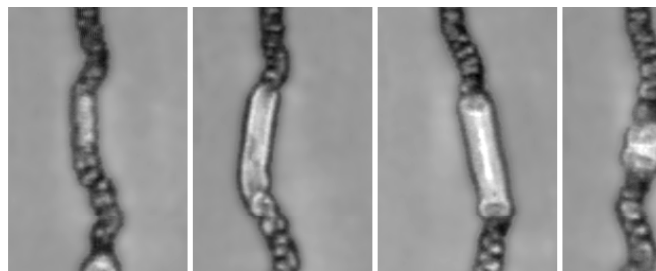
FIG. 3 – Oscillations spatio-temporelles. Le diamètre du gel mesure approximativement 0.7mm dans les parties effondrées et 1.2mm dans les parties gonflées. Les clichés sont pris à 0,20,37,55,95 et 120 minutes environ.
