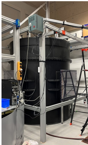
Figure: Schéma et photographie du dispositif expérimental : une cuve cylindrique de hauteur 2.5m et de diamètre 2.15m. Objectif : atteindre une séparation d'échelle Fr \ll \omega^* \ll Re .
