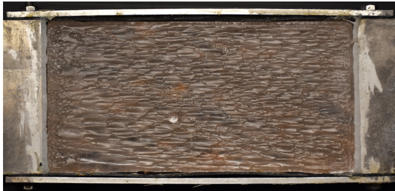
Figure 1. Motifs sur la surface inférieure d'un bloc de sel rose (20 cm x 10 cm), après 20 minutes de dissolution dans un canal hydraulique avec une vitesse d'écoulement de 15 cm/s (de la gauche vers la droite).
