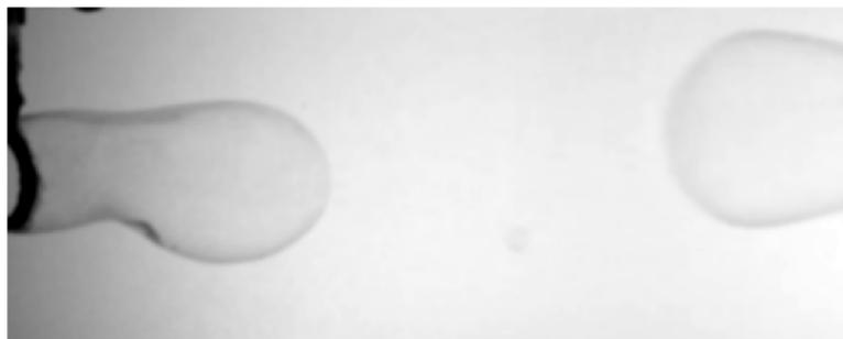
Détachement d'une bulle au cours du temps. Anneau de diamètre moyen  $D_{out} = 4,1$  cm.
