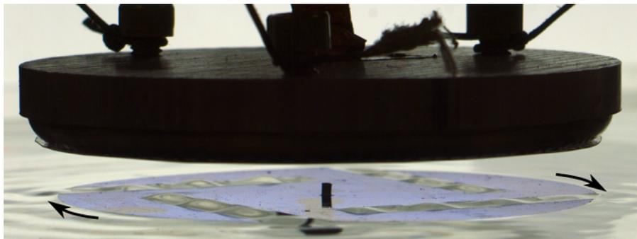
**Figure 1.** Le moteur est un disque de plastique percé de 4 fentes dans lesquelles sont excitées paramétriquement des ondes grâce à une électrode circulaire. Ces ondes devenues propagatives en sortant des fente permettent la mise en rotation du disque par pression de radiation.
