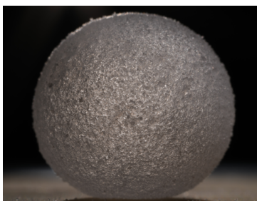
Figure 1. Bulle composite de rayon 3.7 mm, 1 mois après sa formation, sa rupture est observée après 465 jours.
