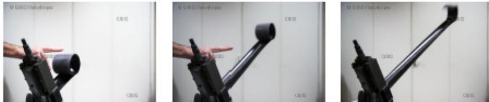
**Figure 1.** Déploiement dynamique d'un ruban bistable.
