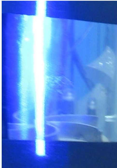
FIGURE 1. Un plan laser est envoyé dans un plan méridien de la cellule de von Kármán.
