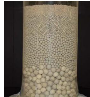
Lit dense – Particule sphériques Porosité \approx 40%
