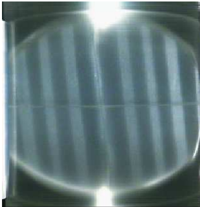
Fig. 6. Zones de cisaillement axisymétriques excitées par les marées dans le cas d'un forçage incliné d'environ 5^\circ par rapport à l'axe de rotation (Ekman de 10^{-5} ).
