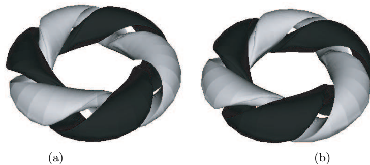
Fig.3. Isosurfaces de la composante azimutale de \mathbf{H} avec 25% du maximum (en noir) et 25% du minimum (en blanc), pour le cas 'Tore' à deux instants : (a) t = 1 et (b) t = 2 \sim 1 + T/4 avec T la période.
